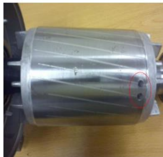
Figura 8 – Rotor com duas barras danificadas
