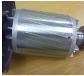
Figura 7 – Rotor com uma barra danificada.
